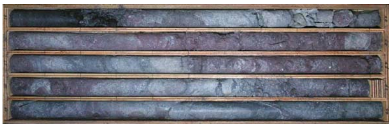
写真-1 掘削直後のコアの状態（鉛直孔・採取深度 25～30m）
