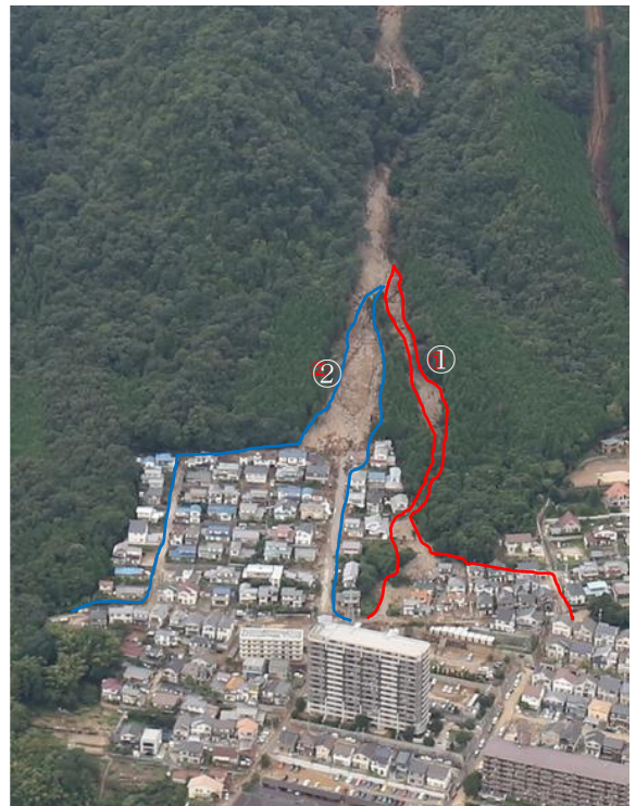
写真 1 土石流の分岐状況
