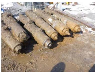
写真 2. 掘り起こした補強材
