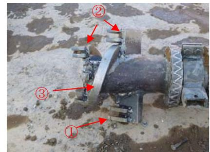
写真1. 硬質地盤用攪拌翼
