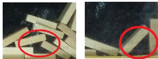
(a) Pancake collapse (b) Lean-to collapse 図 3 特徴的な崩壊形態
