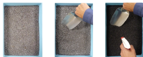
(a) 自然含水比 w_n , (b) 自然含水比 w_n , (c) 含水比 炉乾燥( w=0\% ) 炉乾燥( w=0\% ) w=3\%, 7\% +攪拌無 +攪拌有 +攪拌有
