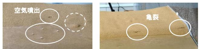
図-3 降雨強度 80-90mm/hr 時に見られたエアブローと亀裂発生の様子
