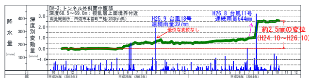
図-3 台風 11 号降雨時の孔内傾斜計変動量図
