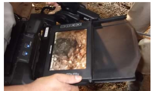
写真-1 工業用内視鏡によるビット前方映像(花崗岩地山の例)
