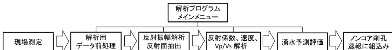
図-1 切羽前方湧水予測の測定・解析・評価ならびに前方探査の総合化
