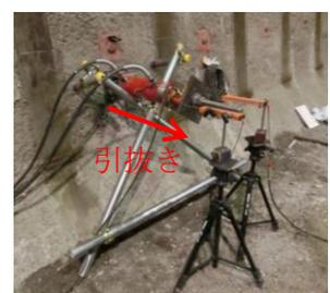
写真-3 現場引抜き試験状況
