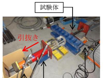
写真-2 室内引抜き試験状況
