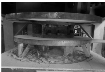
写真-1 隣接破碎状況
