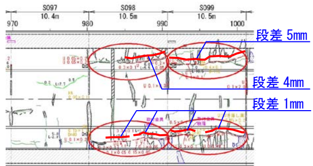
【図 3-1】画像計測による変状展開図
