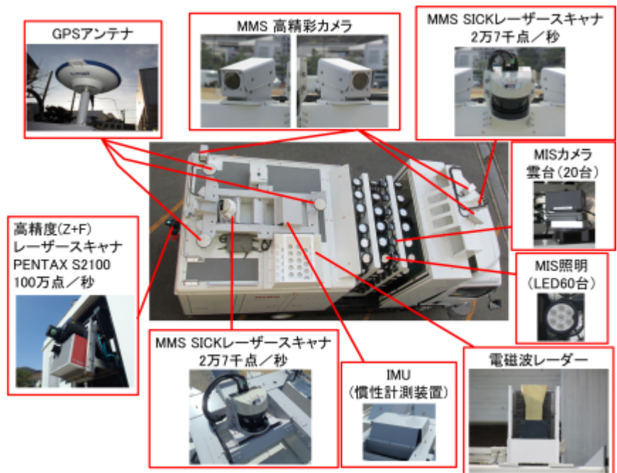
図-1 走行型計測システムの概要 (MIMM-R)
