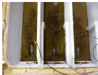
(b)土壌水分計の設置状況
