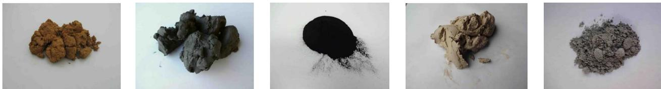
(a) 粘土キラ (b) 砂キラ (c) 集塵ダスト (d) 水洗ケーキ (e) 製鋼スラグ
