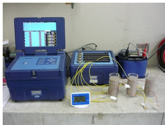
写真-2 測定状況
