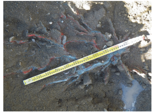
図3 土槽ピット注入試験の掘り起し状況
