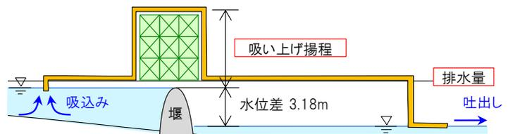
1度目の実験は、多摩川ニケ領宿河原堰(神奈川県川崎市)で、排水能力について検証した。堰を挟んだ前後の水位差(実験時は3.18m)を利用して、サイフォン排水を成立させる(写真-4)。河川敷に仮設足場でステージを組んで天然ダムを模擬し、排水管設置延長は67.5m
