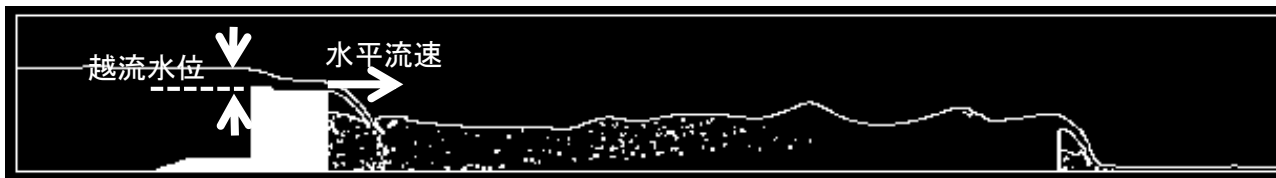
図-2 計算状況可視化の一例 (パラペット小, 下げ幅 0.5m, 越流水位 3m)
