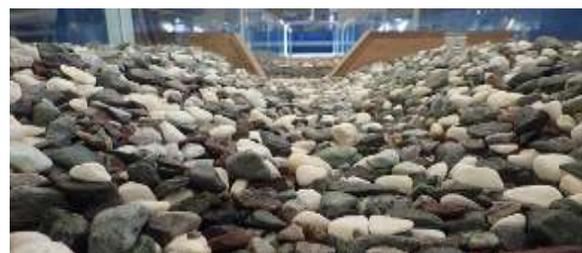
写真1 えん堤上流側の礫による堆積状況
