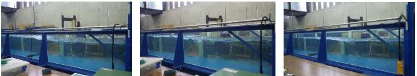
1) バップルで制御した状態 (Case 1)    2) 不安定偏向流況 (Case 2)    3) バップルで制御した状態 (Case 3)
