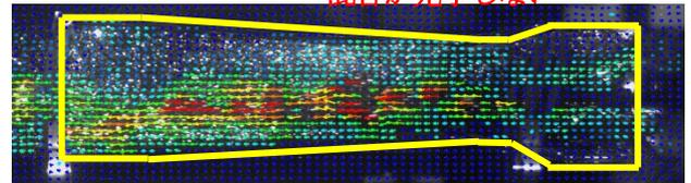
図10 漸変管の口径 1.3cm での解析結果
