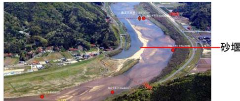
図-1 砂堰の設置状況と砂州の形成
