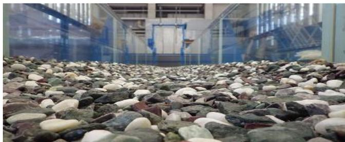
写真1 緩傾斜型台形断面とした状態
