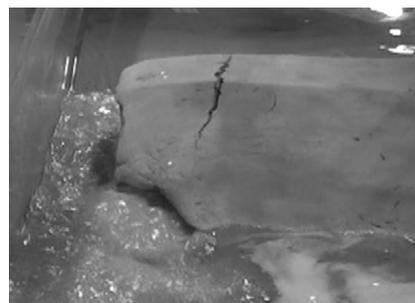
図6 8号砂堤体時の側方侵食状況
