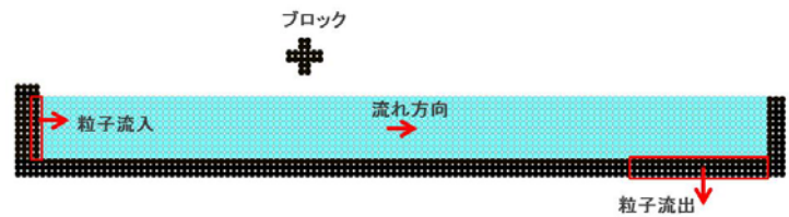
図-2 計算粒子の配列及び粒子の流入・流出箇所
