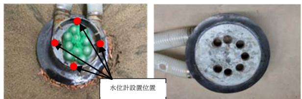
図-2 φ100mm模型吸引部(直径300mm, 吸引口7個φ50mm, 重量30kg)
