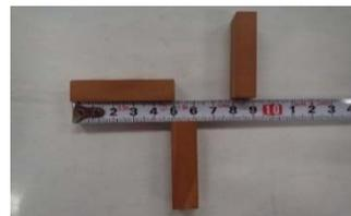
図-3 塵芥模型(ケミカルウッド10mm×10mm×50mm 比重1.1)
