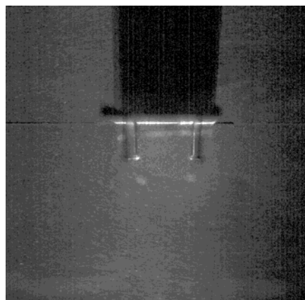
図 5 2 主 I 桁橋モデルまわりの流れ (瞬時画像)
