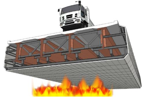
図1 耐火パネルによる橋梁の耐火工
