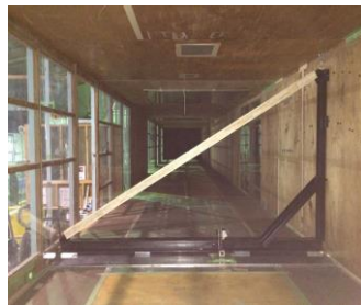
写真1 模型設置状況 (偏角β=0°)
