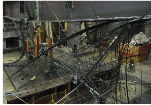
写真-1 GC1 における CFRP 板の引張破壊の状況
