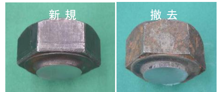
写真-3 ボルト頭部の重量測定試
