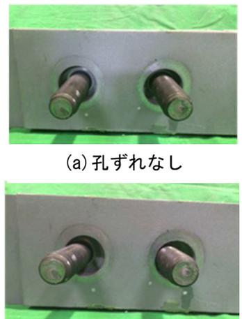
図-2 母板と連結板の孔ずれ
