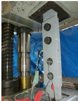
写真-1 すべり試験の実施状況
