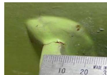
写真4 亀裂拡大写真 (mm)
