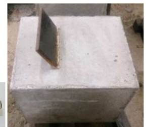
図-4 埋込試験体
