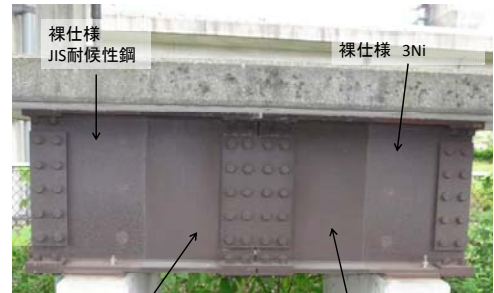
さび安定化補助処理仕様 JIS耐候性鋼 さび安定化補助処理仕様 3%Ni 図1 模擬試験体外観(約15年経過)
