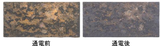
図2 通电前後のさび鋼板の外観
