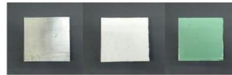
(a)裸鋼板 (b)断熱塗料 (c)フッ素樹脂塗料
