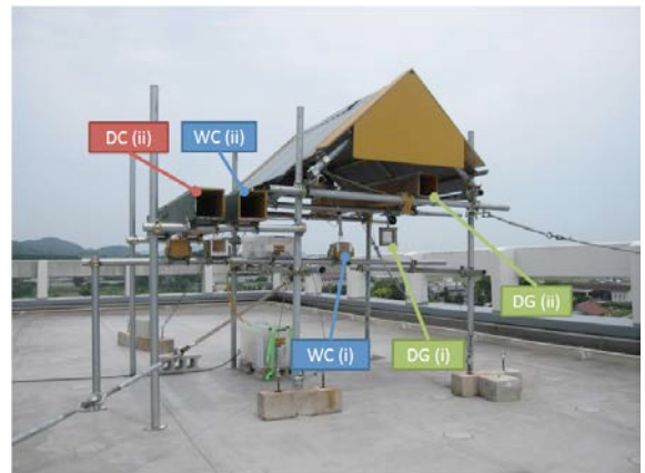
図 1 飛来塩分捕集状況. DG: ドライガーゼ法, WC: ウェットキャンドル法, (i)筒の外での観測, (ii)筒の中での観測.
