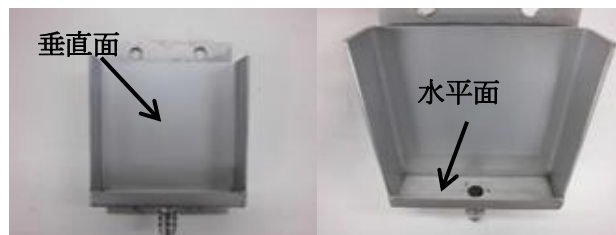
写真2 付着塩分量測定に用いた鋼板
