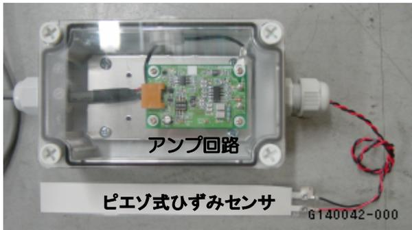
図-3 ピエゾ式ひずみセンサ
