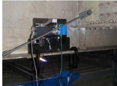
図-3 加速度センサおよびレーザー変位計ターゲット設置状況
