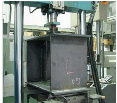
写真1 疲労試験の様子
