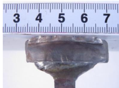
写真5 疲労破面例 (No.1 R側)
