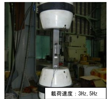
写真-1 疲労試験の状況
