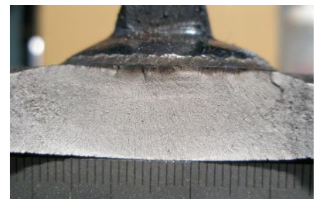
写真-3 試験体 N_{toe}+ICR 3 のき裂破面
