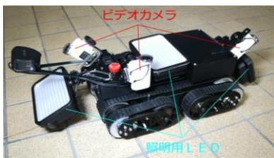
写真-1 狭隘部点検用ロボット
