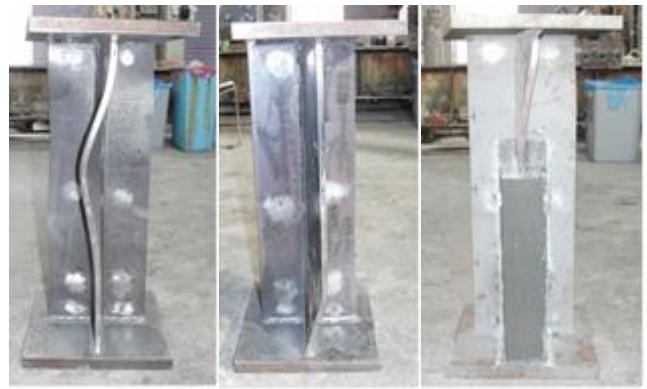
Fig.3 破壊性状 (左から、無腐食・無補修・補修供試体)
