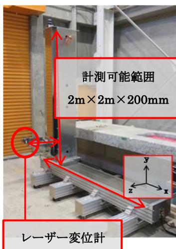
写真 1 タワー型 3D 腐食表面形状計測装置
