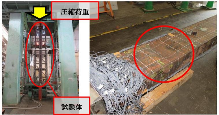
写真2 載荷試験装置 写真3 部材変形状況 (CaseA1)
