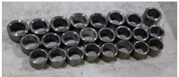
図-2 ボルト孔に充填したリング状の鉛
