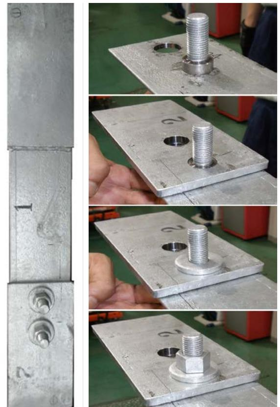
図-4 供試体の組み立て手順
