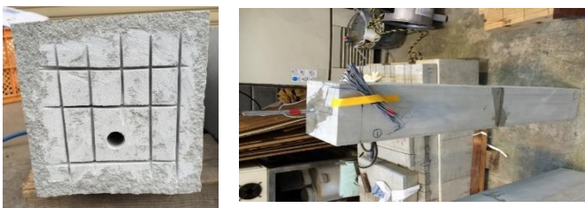
写真3 破断面と補修後の供試体
