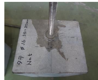
写真2 アンカー棒引き抜き試験
