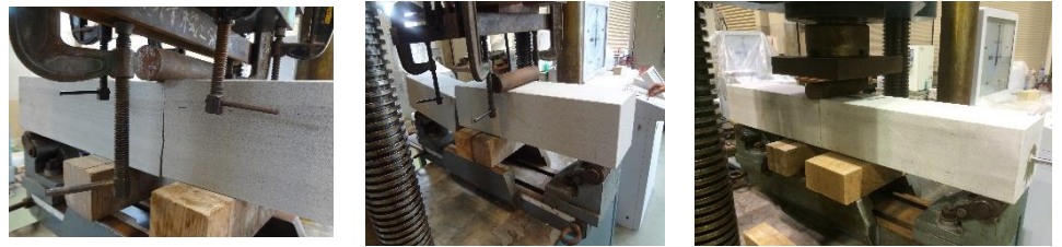
(a) 補修前の破断状況 (b) 補修前の破断状況 (c) 補修後の破断状況 (3点載荷) (4点載荷) (3点載荷)
